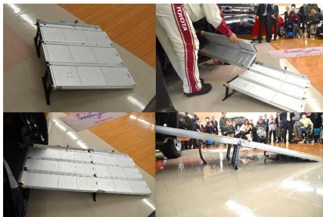
▲スロープは、2枚を組み合わせて使います。 (1.5メートル・角度14度)
